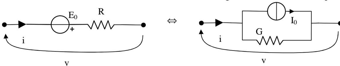
Figura 17. Circuiti equivalenti del generatore reale.
