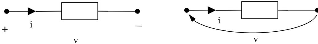
Figura 6.a Versi di riferimento associati (secondo la scelta dell'utilizzatore) per la tensione e la corrente di ramo. A destra, l'indicazione del “-” e del “+” è sostituita da una freccia che indica il terminale positivo.
