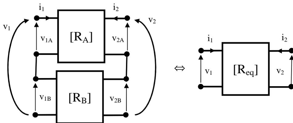
Due doppi bipoli A e B si dicono in parallelo quando sia le porte di ingresso che quelle di uscita sono collegate in parallelo (ovvero i primari sono soggetti alla stessa tensione  $v_1$  ed i secondari sono soggetti alla stessa tensione  $v_2$ ). Tale collegamento da luogo ad un doppio bipolo equivalente la cui matrice delle conduttanze è data dalla somma delle matrici delle conduttanze di A e di B:  $[G_{eq}] = [G_A] + [G_B]$ . Infatti:
