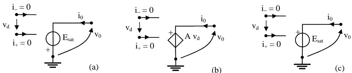
Figura 24 Circuiti equivalenti dell'A.O. a guadagno finito: (a) per la regione di saturazione negativa; (b) per la regione lineare; (c) per la regione di saturazione positiva.
