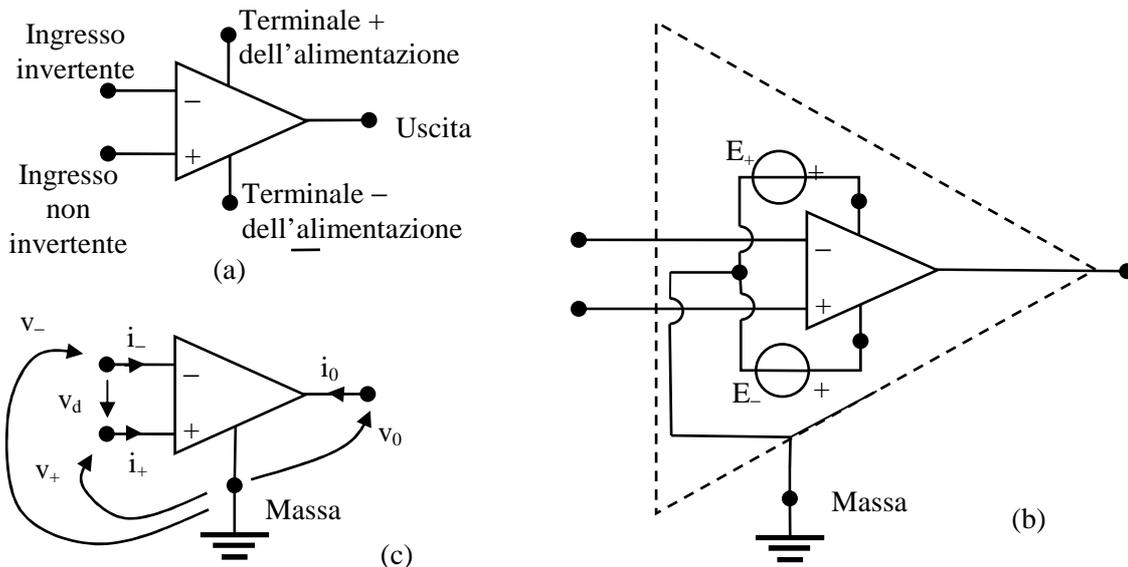
Figura 21 - Amplificatore operazionale [Un simbolo di A.O. che è molto utilizzato in pratica mostra solo tre terminali, omettendo il terminale di massa. Ciò è dovuto al fatto che il terminale di massa in figura 21.b non esiste fisicamente come piedino ma piuttosto viene creato esternamente tramite l'alimentazione. Si è preferito evidenziare esplicitamente il terminale di massa perché altrimenti l'applicazione della LKC avrebbe fornito la relazione errata  $i_- + i_+ + i_0 = 0$ .]
