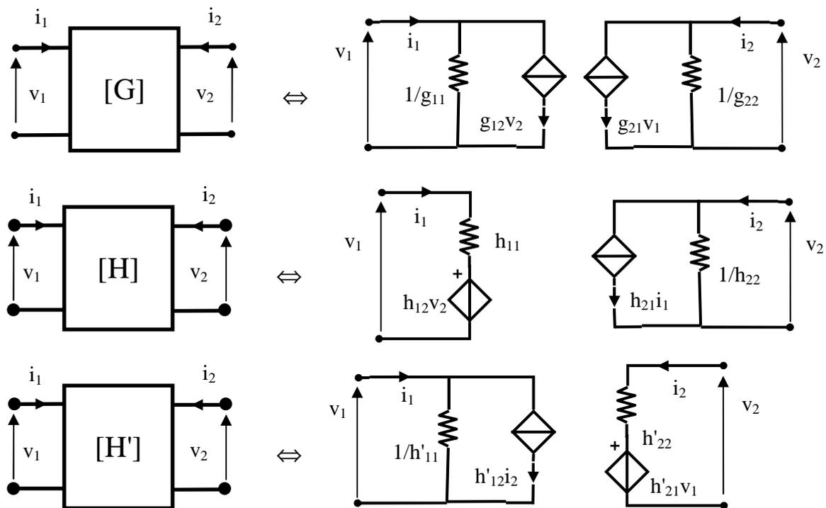
Due doppi bipoli A e B si dicono in serie quando sia le porte di ingresso sia quelle di uscita sono collegate in serie (ovvero la stessa corrente  $i_1$  circola sui primari e la stessa corrente  $i_2$  circola sui secondari). Tale collegamento da luogo ad un doppio bipolo equivalente la cui matrice delle resistenze è data dalla somma delle matrici delle resistenze di A e di B:  $[R_{eq}] = [R_A] + [R_B]$ . Infatti:
