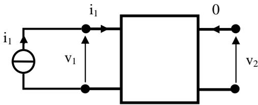
1) posto  $i_2 = 0$ , il primario è alimentato con una corrente  $i_1$  arbitraria. Risolto il circuito per determinare  $v_1$  e  $v_2$ , si ha quindi:
