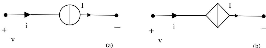
Figura 14. Generatore di corrente: (a) indipendente, (b) pilotato.
