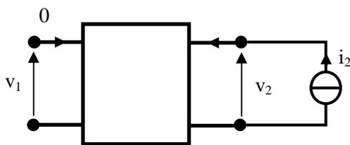
2) posto  $i_1 = 0$ , il secondario è alimentato con una corrente  $i_2$  arbitraria. Risolto il circuito per determinare  $v_1$  e  $v_2$ , si ha quindi:
