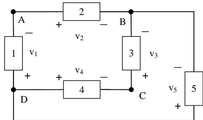
Figura 4. Circuito costituito da 5 bipoli e 4 nodi.
