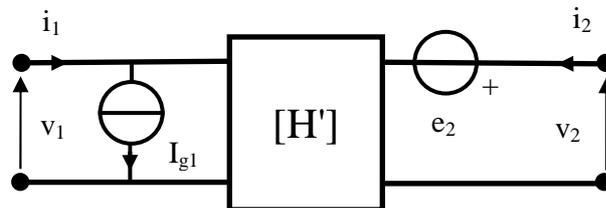
Dato quindi un doppio bipolo lineare non omogeneo e scelta una rappresentazione, i termini noti si possono calcolare specializzando le caratteristiche (annullando le variabili indipendenti). Ad esempio, per calcolare le tensioni  $e_1$  ed  $e_2$  in un doppio bipolo controllato in corrente è sufficiente risolvere il circuito in figura:
