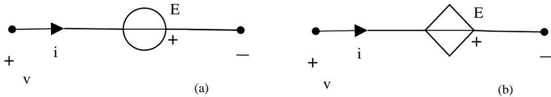
Figura 13. Generatore di tensione: (a) indipendente, (b) pilotato.
