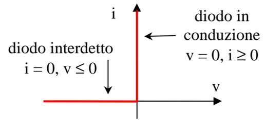
Figura 18.b Caratteristica del diodo ideale, purchè i versi di tensione e corrente siano scelti come in figura 18.a (la caratteristica dipende dalla scelta dei versi).
