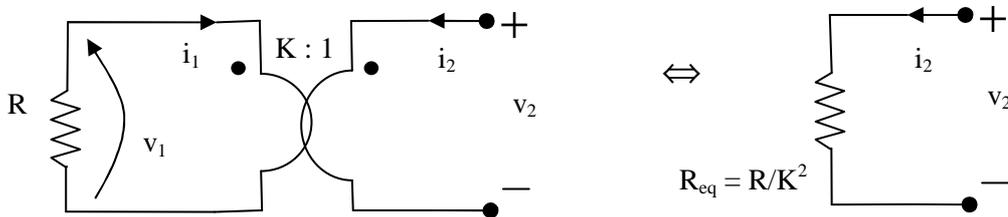
Figura 19.b - Riduzione da primario a secondario di un resistore.
