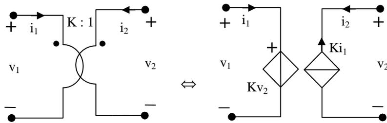
Figura 19 - Trasformatore ideale e circuito equivalente.
