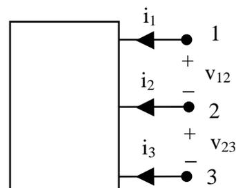
Figura 2. Componente a tre terminali (tripolo).
