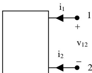
Figura 1. Componente a due terminali (bipolo).
