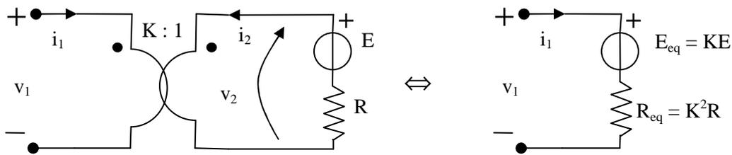
Figura 20 - Riduzione da secondario a primario di un generatore reale.
