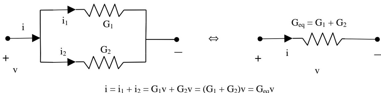
(\*) Se si utilizzano le resistenze si ottiene  $R_{eq} = R_1 R_2 / (R_1 + R_2)$
