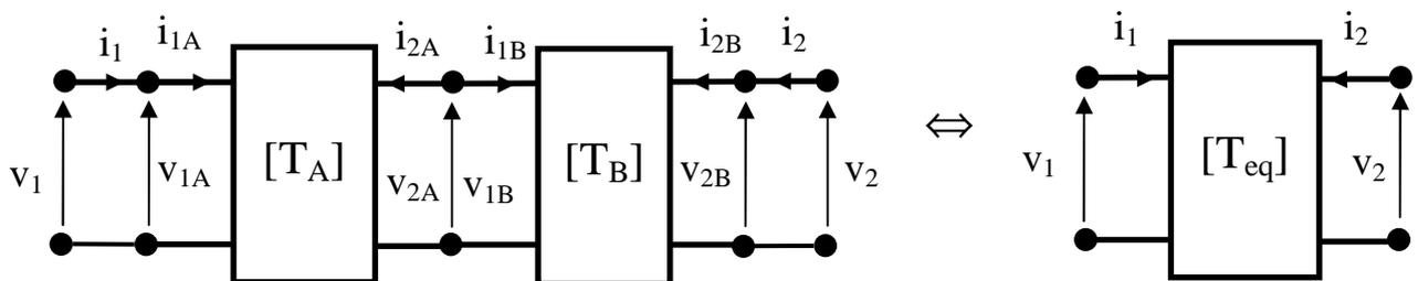
Per quanto riguarda i doppi bipoli non omogenei, se sono rappresentabili in tramite matrice di resistenze, di conduttanze, ibrida diretta od ibrida inversa i termini noti possono essere considerati come un generatore indipendente di tensione in serie alla porta (se la variabile dipendente è una tensione) o come un generatore indipendente di corrente in parallelo alla porta (se la variabile dipendente è una corrente):
