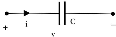
Figura 12. Condensatore lineare.
