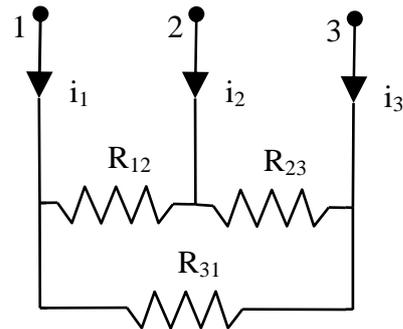
Figura 10.b – Triangolo di resistori
