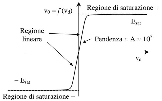
Figura 22 Caratteristica di trasferimento.
