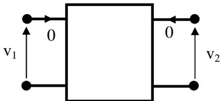
Posto  $i_1 = i_2 = 0$ , e risolto il circuito per determinare  $v_1$  e  $v_2$ , si ha quindi:
