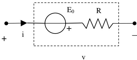
Figura 16.a Modello circuitale del generatore reale.
