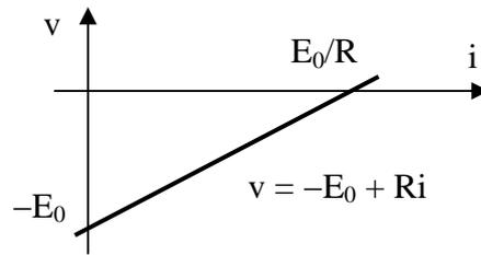
Figura 16.b Caratteristica del generatore reale.
