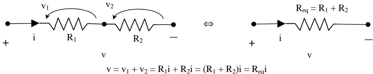
Figura 9.a Resistori collegati in serie
