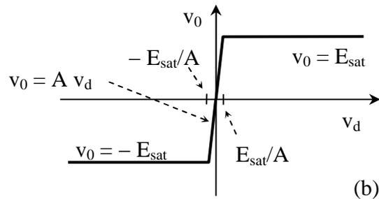
Figura 23 Modello di A.O. a guadagno finito
