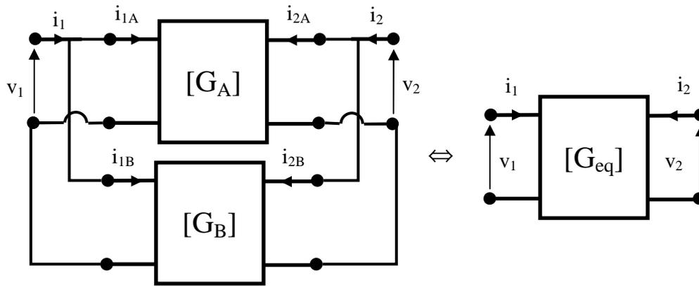
Due doppi bipoli A e B si dicono in serie-parallelo quando porte di ingresso sono collegate in serie e quelle di uscita sono collegate in parallelo. Tale collegamento da luogo ad un doppio bipolo equivalente la cui matrice ibrida diretta è data dalla somma delle singole matrici ibride dirette, ossia:  $[H_{eq}] = [H_A] + [H_B]$ . La dimostrazione è analoga ai casi precedenti.
