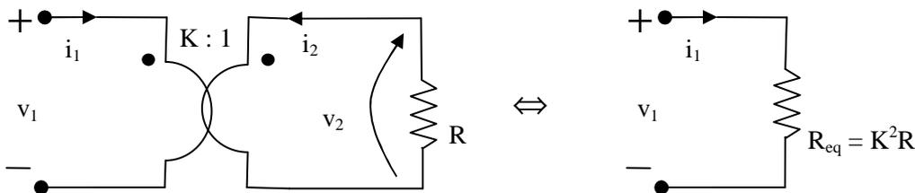
Figura 19.a - Riduzione da secondario a primario di un resistore.
