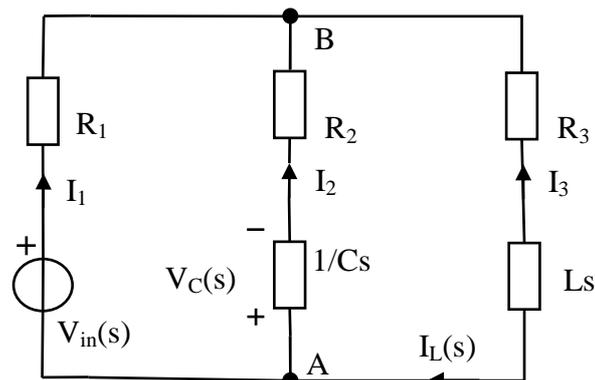
Figura 6.b - Circuito nel dominio di Laplace, supponendo nulle le condizioni iniziali.
