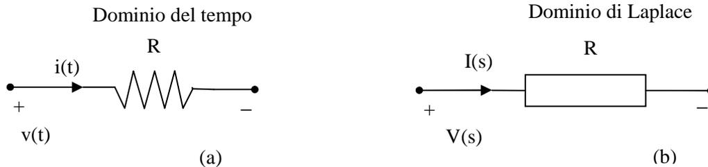
Figura 5 Resistore lineare: (a) nel dominio del tempo, (b) nel dominio di Laplace.
