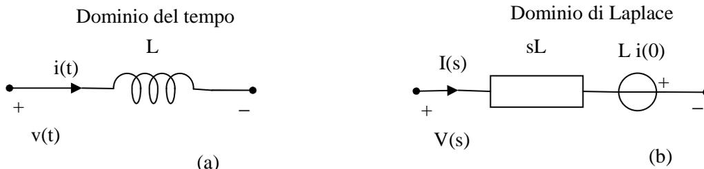
Figura 6 Induttore lineare: (a) nel dominio del tempo, (b) nel dominio di Laplace.
