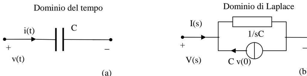
Figura 7 Condensatore lineare: (a) nel dominio del tempo, (b) nel dominio di Laplace.
