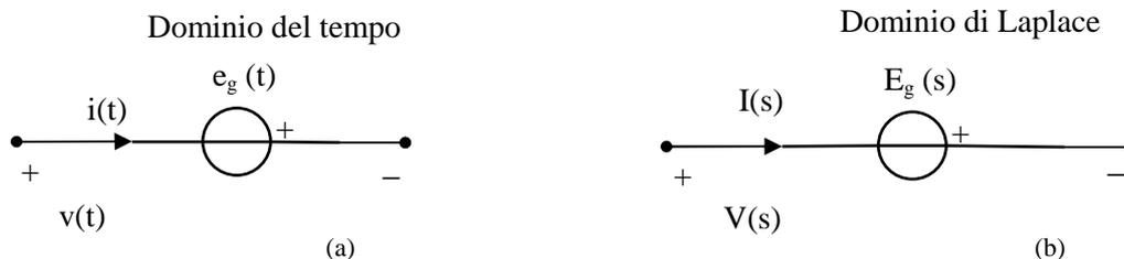
Figura 3 Generatore di tensione indipendente: (a) nel dominio del tempo, (b) nel dominio di Laplace.
