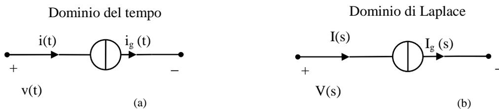
Figura 4 Generatore di corrente indipendente: (a) nel dominio del tempo, (b) nel dominio di Laplace.
